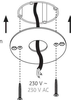
Senkkopfschrauben müssen plan mit dem Deckenring abschließen !
