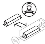
Die Lichtquelle oder das Betriebsgerät dieser Leuchte darf nur durch den Hersteller oder einen von ihm beauftragten Servicetechniker oder eine vergleichbar qualifizierte Person ersetzt werden !
