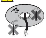
Senkkopfschrauben müssen plan mit dem Deckenring abschließen! The countersunk bolts must be on a level with the
