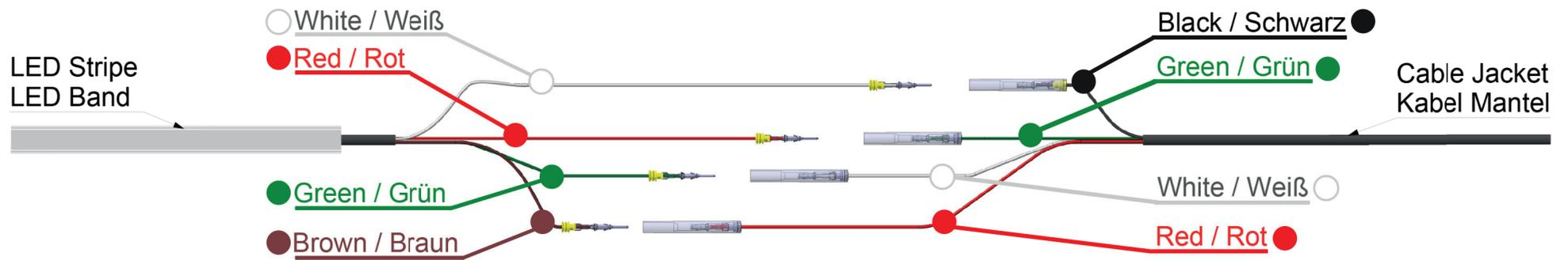
**Weißes Kabel** mit Stecker in Buchse mit **schwarzem Kabel**
